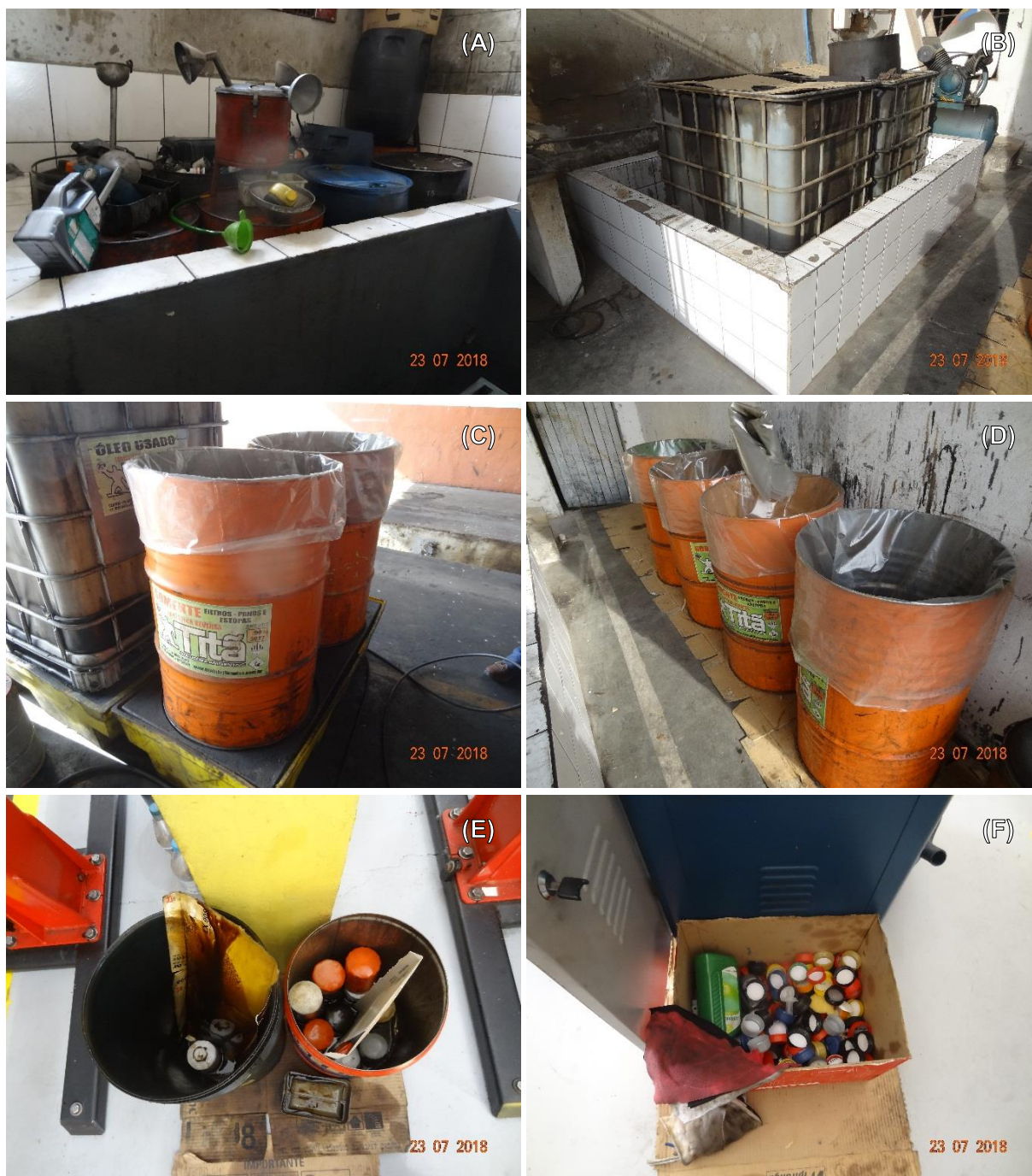
Figura 93 – Algumas formas de acondicionamento de óleos lubrificantes usados e seus resíduos: (A e B) Locais de acondicionamento temporário de óleos usados; (C e D) Tambores metálicos destinados ao acondicionamento de resíduos com contaminação de óleo; (E) Baldes de plástico e metal utilizados para acondicionamento de resíduos com contaminação de óleo; (F) Tampas de recipientes de óleo lubrificante.
