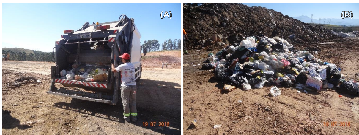
Figura 104 – Momento de descarga do caminhão compactador com os resíduos recolhidos na região selecionada para o estudo gravimétrico, sendo: (A) Veículo pronto para descarregar os resíduos; e (B) Monte de resíduos utilizado para realização da gravimetria.
