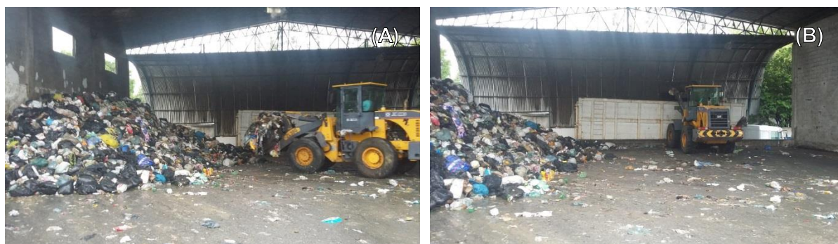
Figura 19 – Operacionalização da ETR, sendo (A) vista da pá carregadeira em atividade; e (B) vista do carregamento da carreta de transporte de resíduos até o aterro sanitário.
