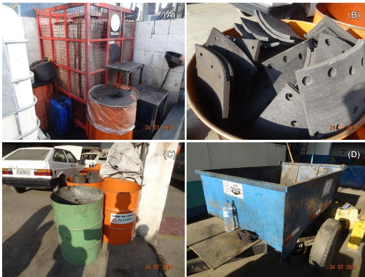
Figura 84 – Formas de acondicionamento de resíduos dos serviços de transporte observadas na empresa Rodoviário e Turismo São José Ltda.: (A) Óleos usados e embalagens plásticas; (B e C) Lonas de freio; (D) Caçamba de acondicionamento de sucatas metálicas.
